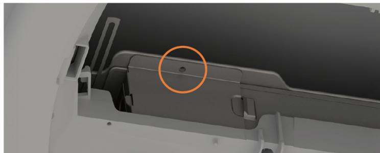
**6.** Remplacer le filtre à maille métallique dans l'enveloppe ADB à l'aide des deux vis fournies.
