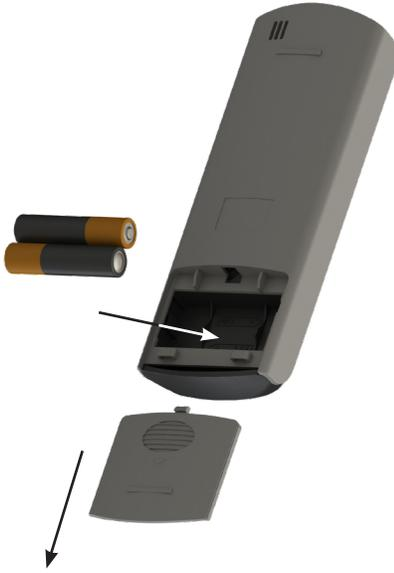
**NOTE:** Pour une performance optimale du produit, ne pas mélanger des batteries anciennes et neuves ou des batteries de différents types
